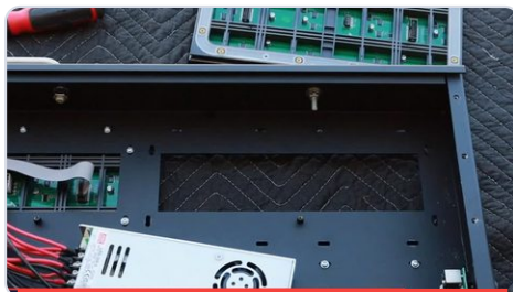
Disconnect module cables
